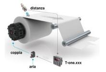
Regolazione in coppia con freno pneumatico/elettromagnetico e regolatore Re
